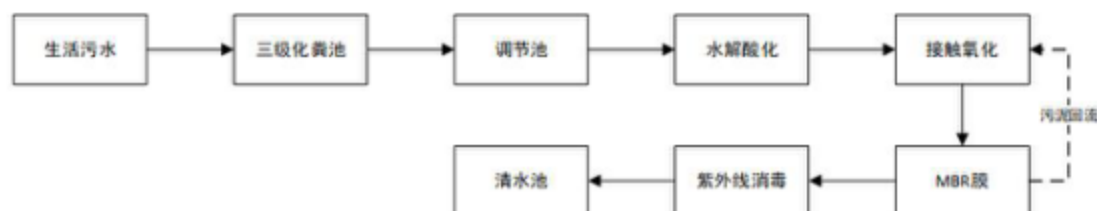
图 4-1 一体化生活污水处理工艺流程图
