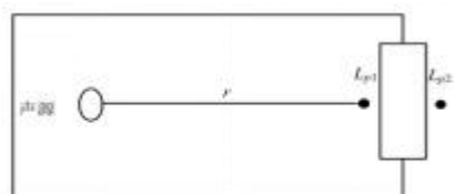
图 A.1 室内声源等效为室外声源图例
