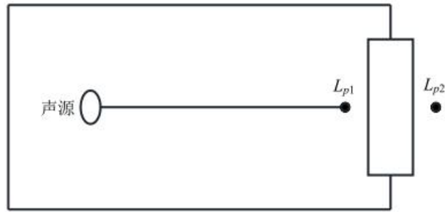
图 4-3 室内声源等效为室外声源图例
